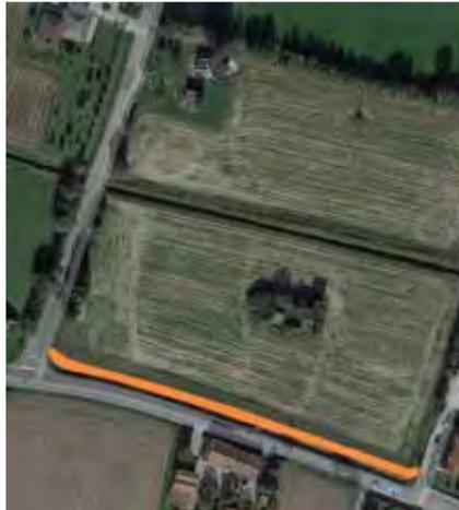
pista ciclabile lungo via Roma. La pista presenta una larghezza pari a 3 metri e si estende da est ad ovest per una lunghezza di circa 200 metri. E' prevista la pavimentazione della pista ciclabile in asfalto. Lungo tutto il versante sud, che costeggia il fossato esi-
